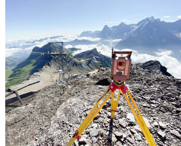
Neubau Schilthornbahn 20XX. Leistungen b+d: Bauabsteckungen, Kontroll- und Überwachungsmessungen
